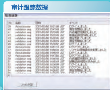
主要的操作内容系统自动记录时间。更改数据时不能覆盖数据，只能调整作为新记录登记。
