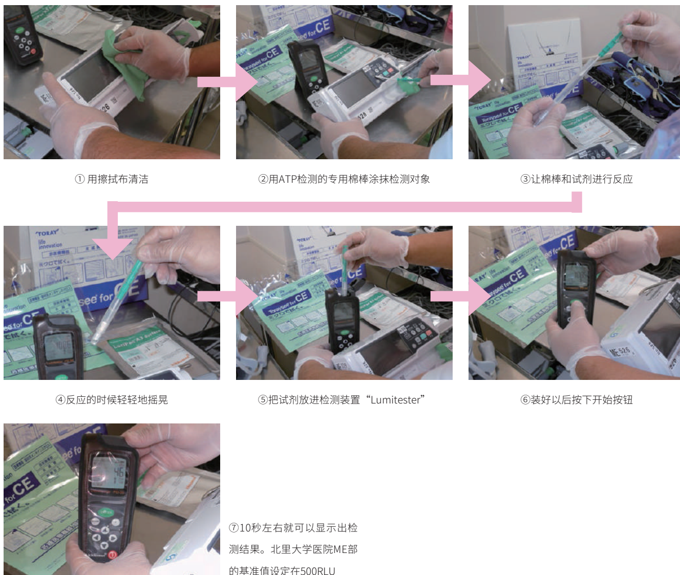
图1 医疗用器材清洁后用ATP检测确认洁净度
